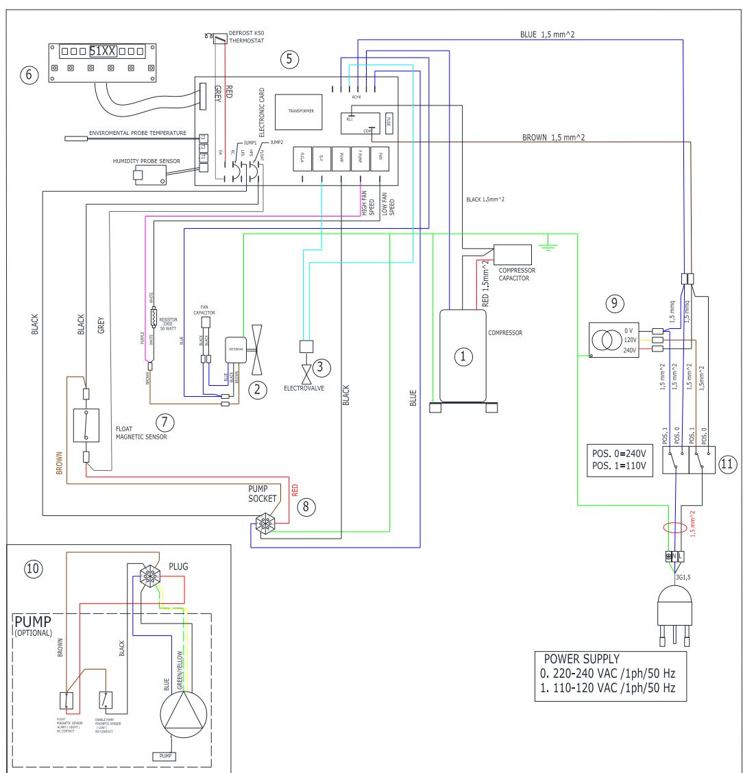
**ELECTRIC SYSTEM - IMPIANTO ELETTRICO - ELEKTRISCHE ANLAGE
