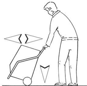
El transporte sobre escaleras o en un plano muy inclinado se hace más fácil si se detiene el equipo de la manera mostrada en la ilustración:
