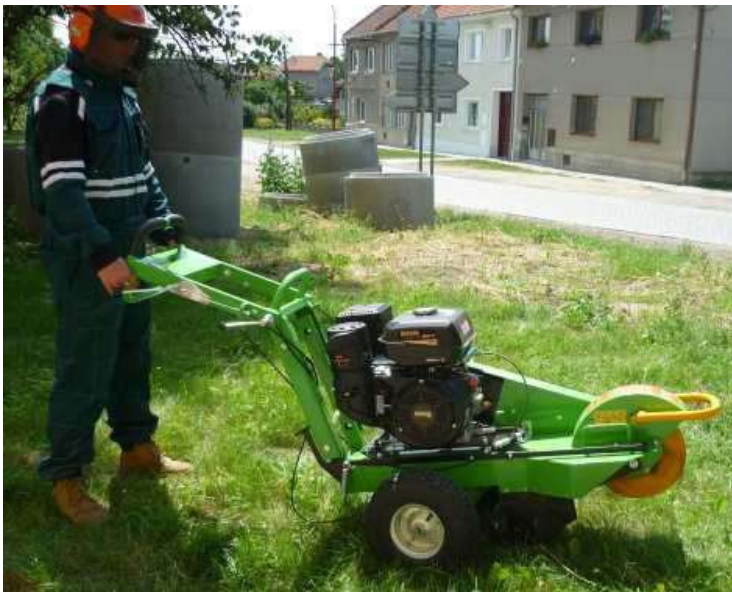
Posición correcta del operario Detrás del manillar
