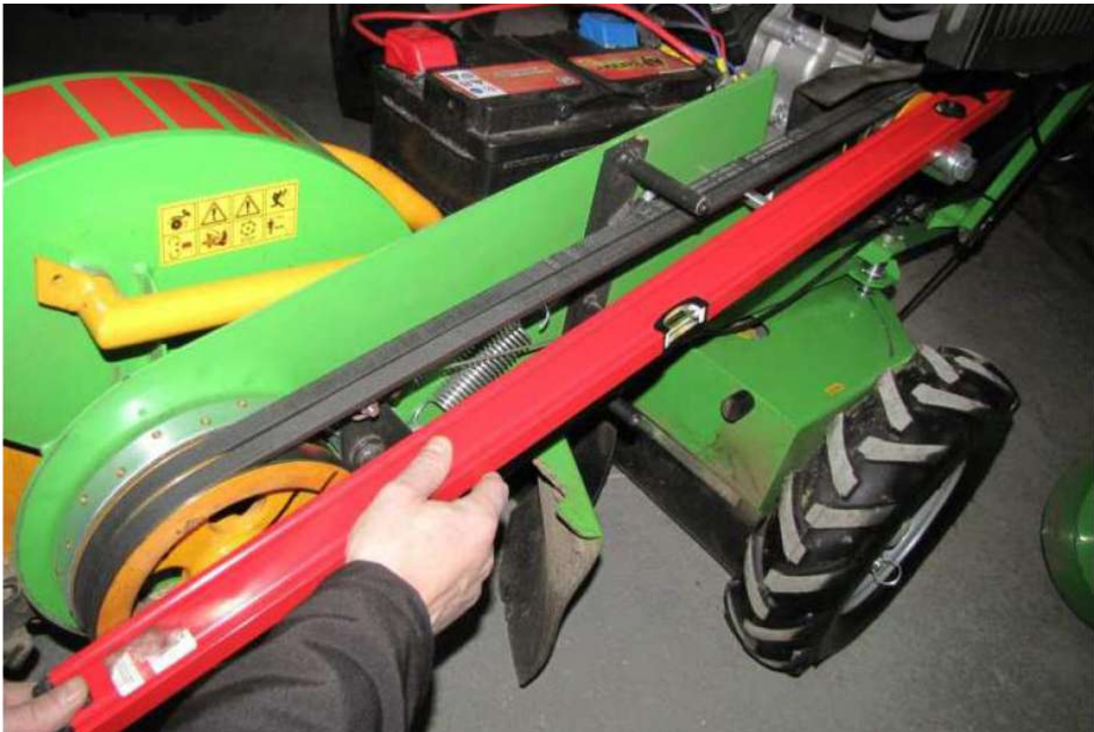
Ajuste de la alineación en la polea del motor
