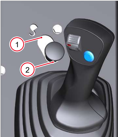
Fig. 78: Palanca de bloqueo modo operativo/modo calle
