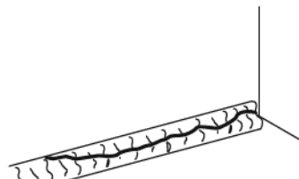
Rotura en soldadura
