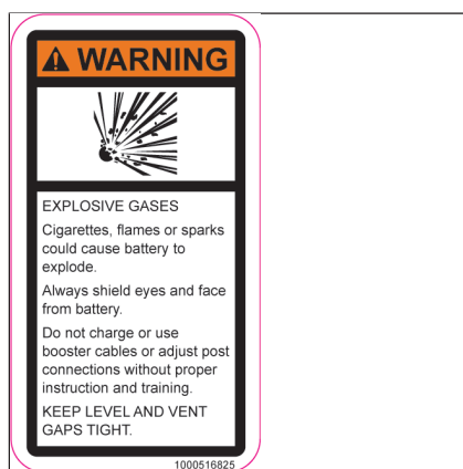
Fig. 58: Batería/riesgo de explosión
