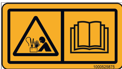
Fig. 20: Riesgo de explosión, batería
