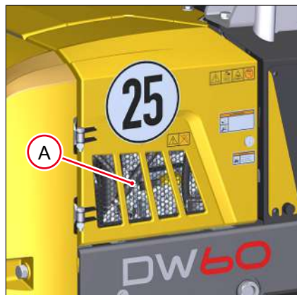
Fig. 225: Rejilla de ventilación
