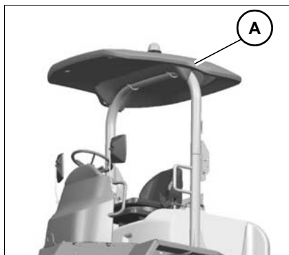
Fig.:70 Tejadillo de protección solar
